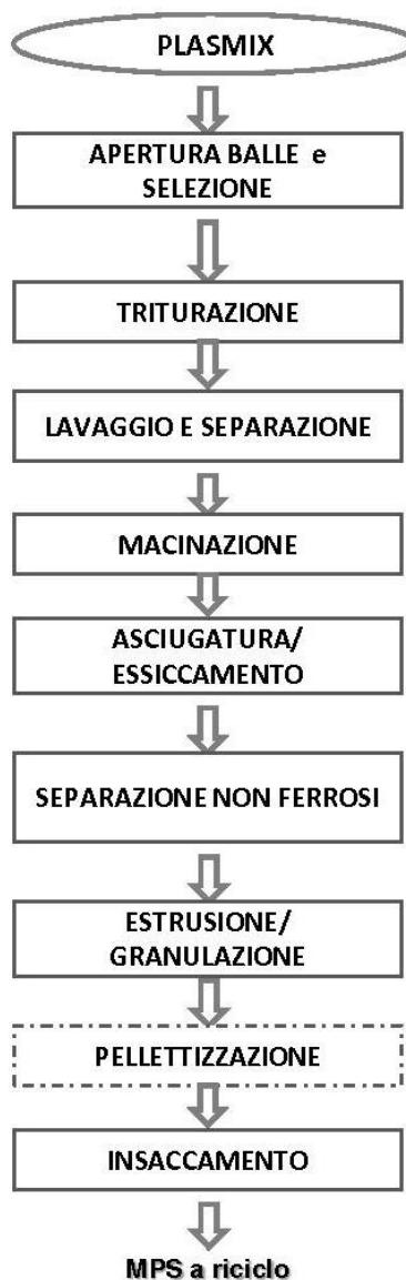
Figura 32. Opzione 1 del LIVELLO 3 FILIERA PLASTICA: Impianti di Lavorazione Plasmix (plastiche miste)
